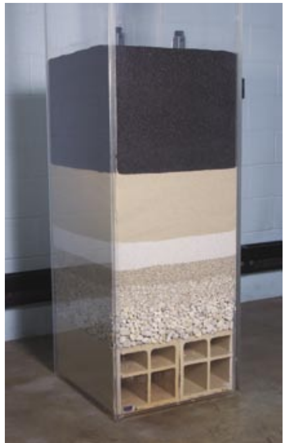
El agua pasa por capas de carbón, arena, y grava en el tanque de filtración de un sistema de agua.
